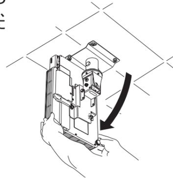
5. ランプカバーのネジをゆるめ、ランプカバーを取り外します。
