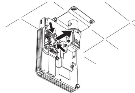
8. 新しいランプを、図のように方向を合わせて奥まで差し込みます。
