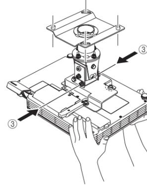
4. プロジェクターを図の矢印方向に回転させて、プロジェクターが縦になるようにします。
