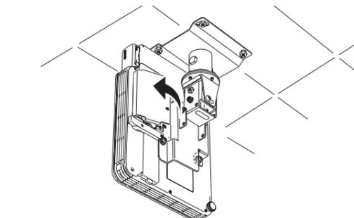
6. ランプカートリッジの3箇所のネジをゆるめます。
